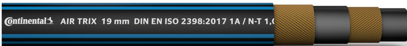
**MARKING:** 2x3 estrias amarelas, evoluindo de forma axial, com uma identificação branca no centro, com base preta "Continental AIR TRIX 19 mm DIN EN ISO 2398:2017 1A / N-T 1,0 MPa (10 BAR / 145 PSI) Made in Germany"
