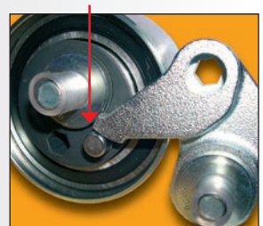
Korrekte Position des Hebels
