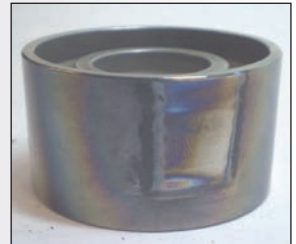
Umlenkrolle mechanisch blockiert (Motorseite oben)
