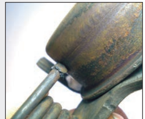
Kontakt der Feder mit dem Laufmantel
