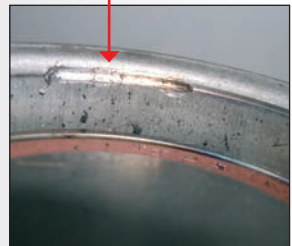
Spannrolle innen mechanisch blockiert
