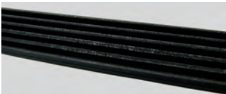
保养件对皮带的化学作用导致皮带失效
