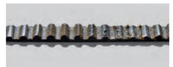
Fissures sur le dos de la courroie
