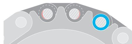
**La chaîne de distribution peut s'allonger en raison de l'usure au niveau des boulons et dans les douilles.**
