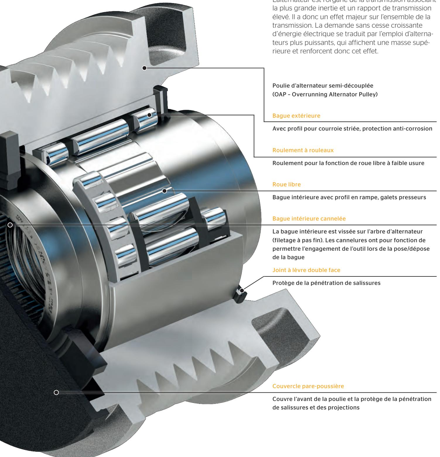
**Poulie d'alternateur semi-découplée (OAP - Overrunning Alternator Pulley)**
