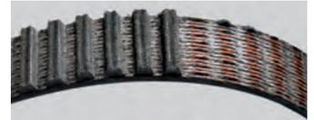
Flancs des dents usés, fissures à la base des dents et dents arrachées
