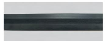
Dégradation de la courroie causée par l'action de produits chimiques
