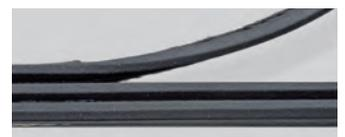
Armature câblée désolidarisée du dos ou du flanc de la courroie
