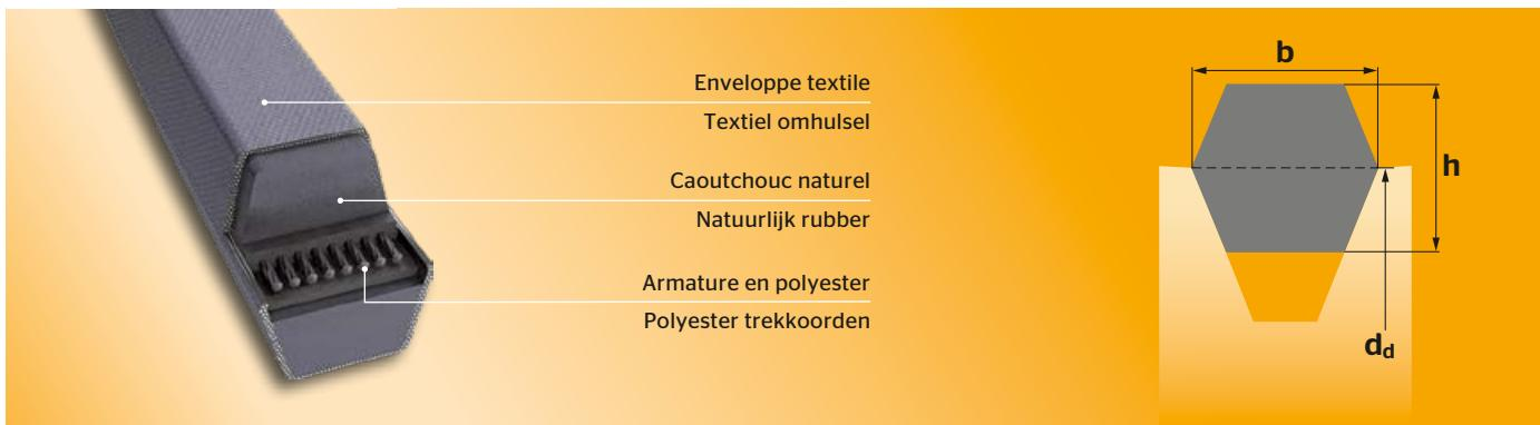
La courroie CONTI<sup>®</sup>V DUAL a été développée pour les transmissions avec inversion du sens de rotation du secteur de l'ingénierie mécanique. La section cunéiforme double de la courroie convient parfaitement aux transmissions avec contre-flexions où les deux faces de la courroie sont utilisées pour transmettre la puissance. Les champs d'application types sont les machines agricoles et de jardinage mais aussi les entraînements de broyeur par exemple.
