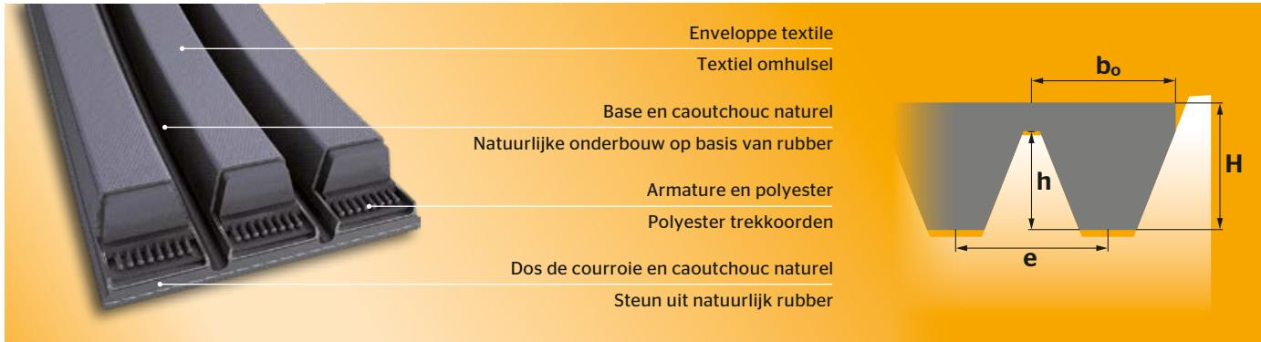
La courroie CONTI<sup>®</sup>V MULTIBELT est généralement utilisée avec des entraxes importants et dans les environnements poussiéreux, par exemple sur les concasseurs de pierres et les fraiseuses à froid. Elle convient également aux applications agricoles. La bande de recouvrement à rigidité transversale évite toute torsion et toute vibration excessive dans les différents brins.
