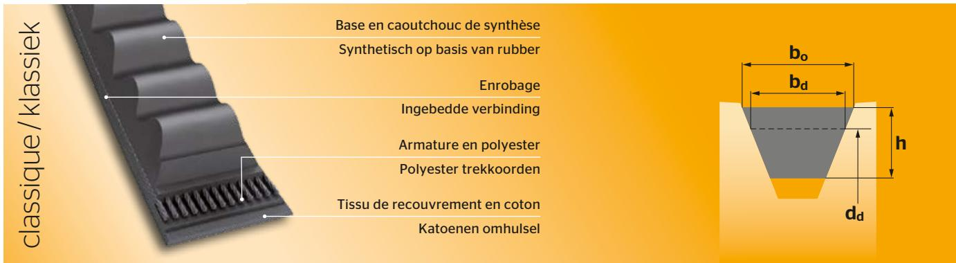
La courroie CONTI<sup>®</sup>V FO a été développée pour les transmissions industrielles à haute vitesse avec des poulies de petit diamètre. Elle convient aux transmissions légères, par exemple des séchoirs et machines de jardinage.
