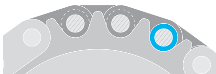
Catena di distribuzione e ruota dentata senza tracce d'usura.
