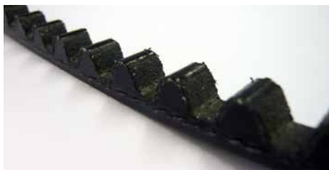
Segni di usura sulla cinghia dentata
