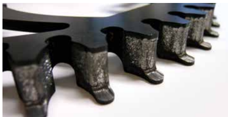
Segni di usura su una puleggia CDS premium o cargo
