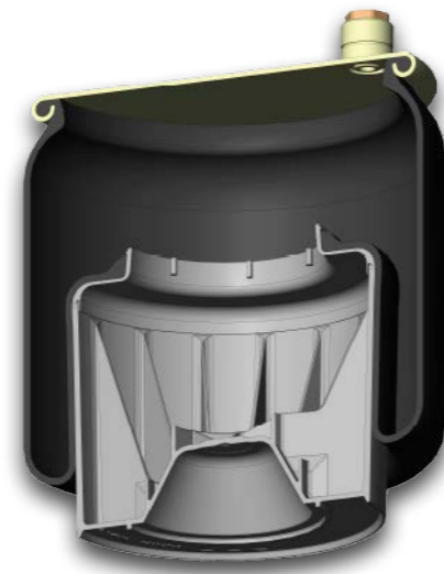
Luftfedersystem mit Kunststoffkolben mit voll genutztem Innenvolumen
