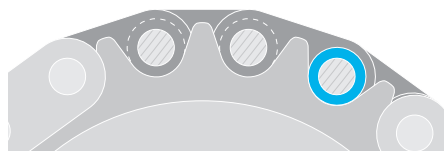
Corrente de distribuição e pinhão de corrente sem marcas de desgaste.
