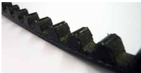
Signes d'usures sur la courroie de transmission
