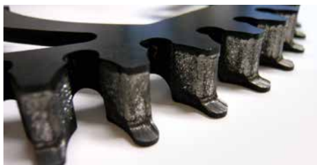
Signes d'usures d'une poulie à courroie CDS premium ou cargo
