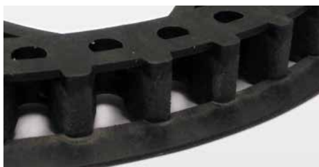
Signes d'usures d'une poulie à courroie CDS eco
