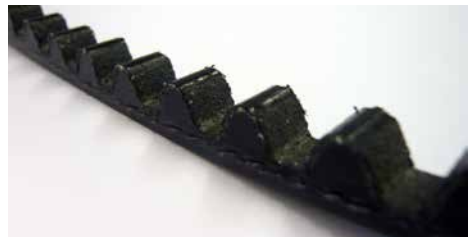
Tekenen van slijtage aan de tandriem
