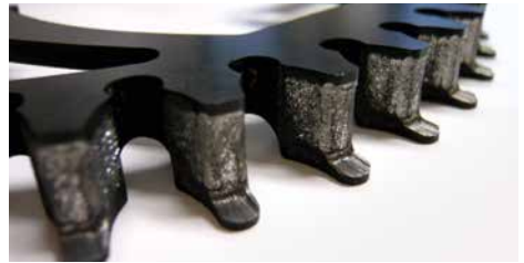
Tekenen van slijtage aan een CDS premium of cargo tandwiel
