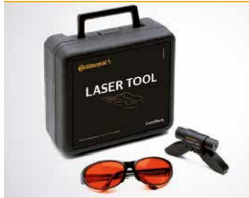
Através do aparelho laser, aplicado na polia, é possível verificar de modo simples o alinhamento correto do acionamento por correia estriada. Fixação sem ímanes - também utilizável com polias de plástico.
