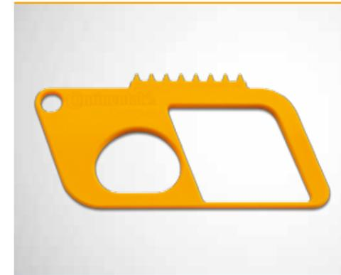
Detetar o desgaste da correia de forma rápida e simples: colocar o verificador de desgaste nas nervuras da correia estriadas parada para detetar o desgaste do perfil da correia.
