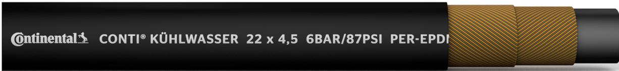
**KENNZEICHNUNG:** Continental CONTI® KÜHLWASSER 22 x 4,5 6 BAR / 87 PSI PER-EPDM/AR/PER-EPDM MADE IN GERMANY
